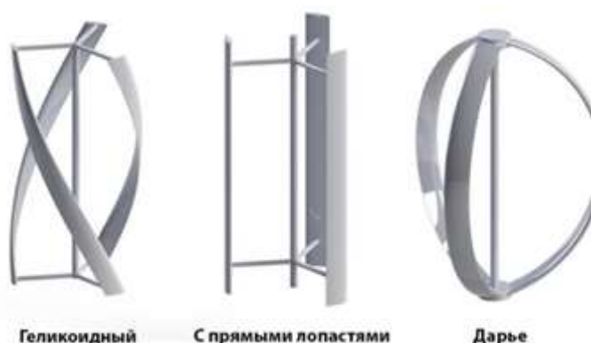
Рис. 2. Виды конструкция вертикальных (ортогональных) ветрогенераторов.
